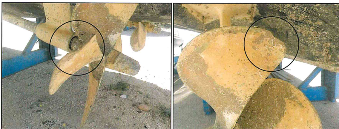
Photos 3 et 4 : pales endommagées
