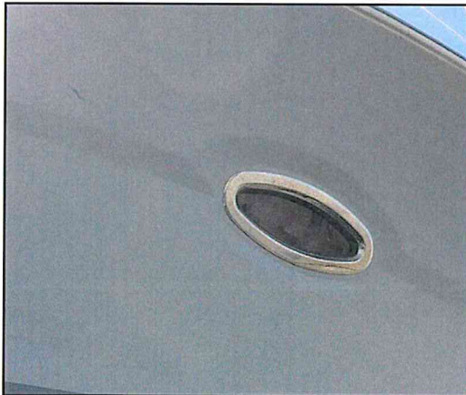
Photo 6 : impact + rayures sur armature hublot
