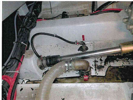
Photos 22 et 23 : sous moteur bâbord eau + huile
