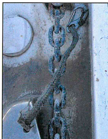
Photo 11 : main de fer coupée
