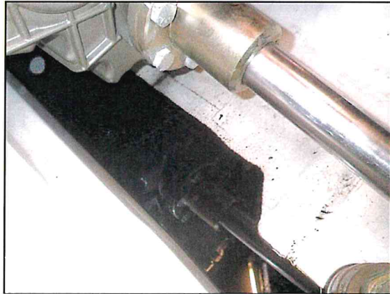
Photo 21 : huile sous moteur tribord
