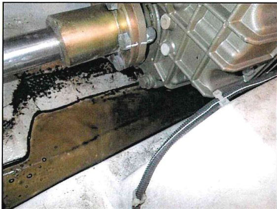
Photos 22 et 23 : sous moteur bâbord eau + huile
